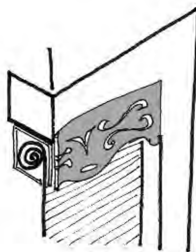
caisson de volet roulant dissimulé derrière un lambrequin
